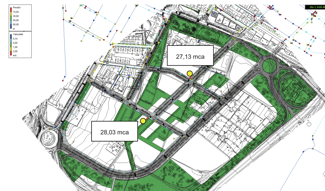
Fig.5 Pressió de dos hidrants consecutius en funcionament en hora punta
